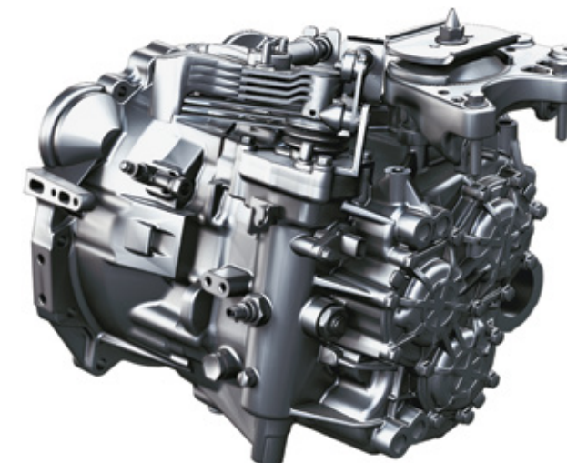
7-ступенчатая коробка передач с двойным сцеплением «мокрого» типа
