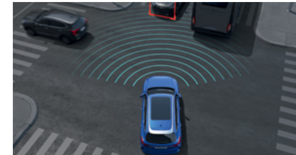
Система предотвращения столкновений при проезде перекрестков
